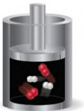
▲ Figura 5.3 Un sistema cerrado y su entorno. En un cilindro con un pistón móvil, se confinan hidrógeno y oxígeno gaseosos. Si sólo nos interesan las propiedades de los gases, éstos son el sistema y el cilindro y el pistón forman parte del entorno. Debido a que el sistema puede intercambiar energía (en forma de calor y trabajo), pero no materia con el entorno, se trata de un sistema cerrado.
